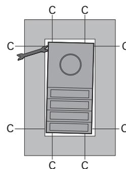
14. Desserrer le verrouillage du support de fonction, détacher le câble de sécurité et mettre de côté le support de fonction avec les modules.
