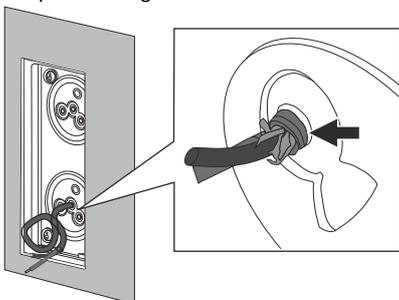
Couper le câble de raccordement à la longueur voulue et le raccorder à la borne enfichable (A). Tourner la borne enfichable à 180° (B) et l'enficher sur le raccordement du module vocal ou de station de porte.
