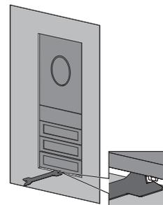
13. Régler les vis de positionnement (C) du boîtier d'encastrement à l'aide de la clé de verrouillage, de manière à ce que la fente entre les modules et la plaque frontale soit symétrique. Serrer ensuite toutes les vis de positionnement.
