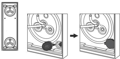
17. Sur le support de fonction avec les modules, brancher d'abord les résistances de terminaison, puis le câble système. Toujours insérer une résistance de terminaison sur le premier et le dernier module du câble système. Respecter le codage des fiches !
