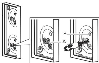
7. Insérer les vis de fixation des coins de montage dans les ouvertures du boîtier. Si la plaque frontale a une épaisseur supérieure à 1 mm, glisser des rondelles sur les vis de fixation et les fixer avec un joint torique pour compenser la hauteur de la plaque frontale.
